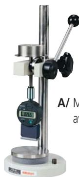
A/ Mesure de dureté avec support
