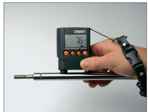
Des pièces cylindriques peuvent aussi être mesurées sans problème.
