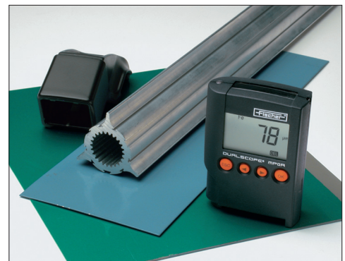
Mesure de couches de peinture, vernis ou anodisées sur Aluminium.
